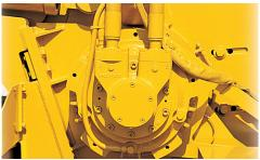
ROTARY POWER TRENCHER DRIVE MOTOR.
